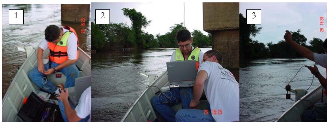
Figura 28. Manutenção da bóia (1) Conexão de cabos para download (2) download via computador ou Shuttle, (3) limpeza de sonda.
