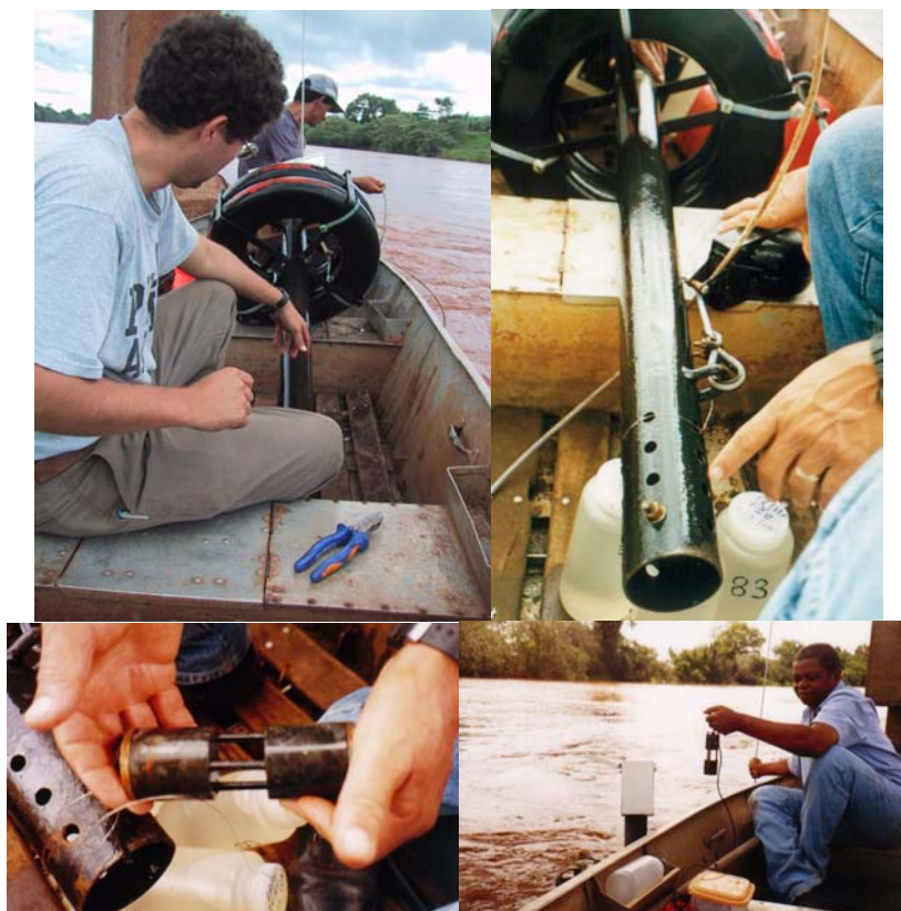
Figura 16. Procedimento de manutenção e download de dados das bóias.
