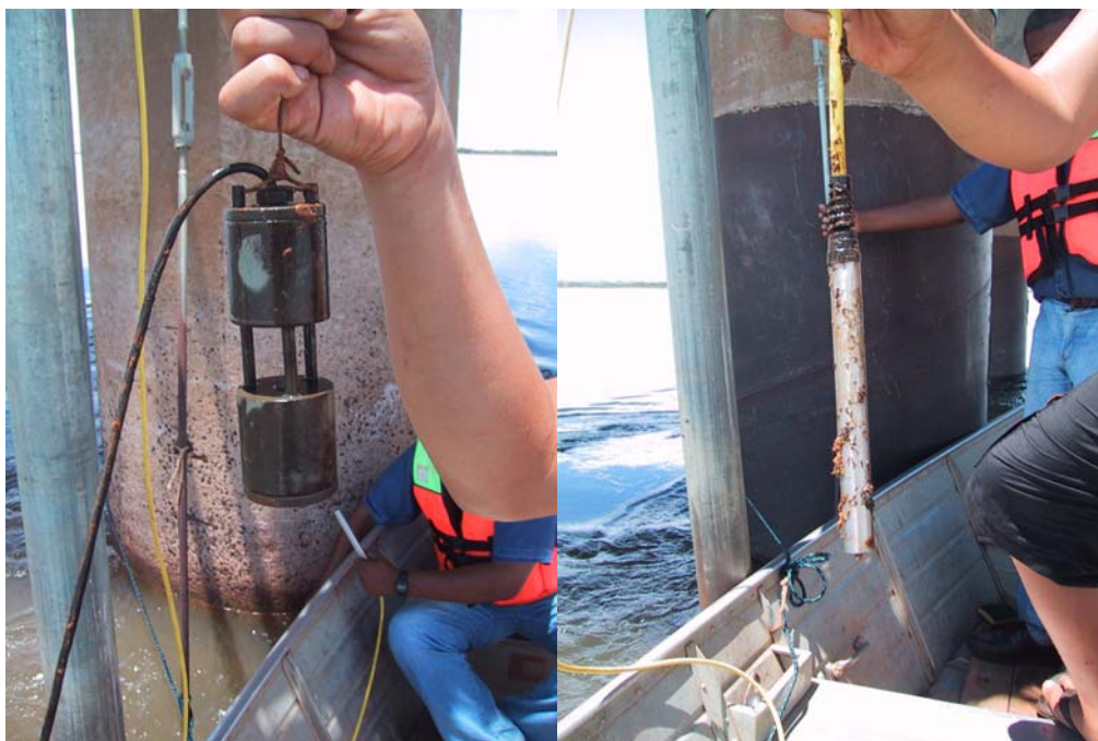
Figura 11. Sondas (sensor) do turbidímetro e do medidor de nível de água.
