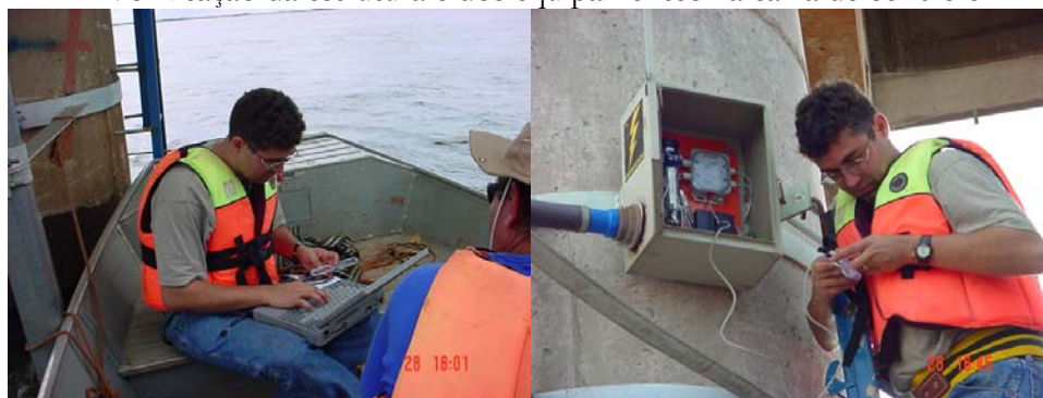
2. Download dos dados com o computador ou com o HOBOT shuttle.
