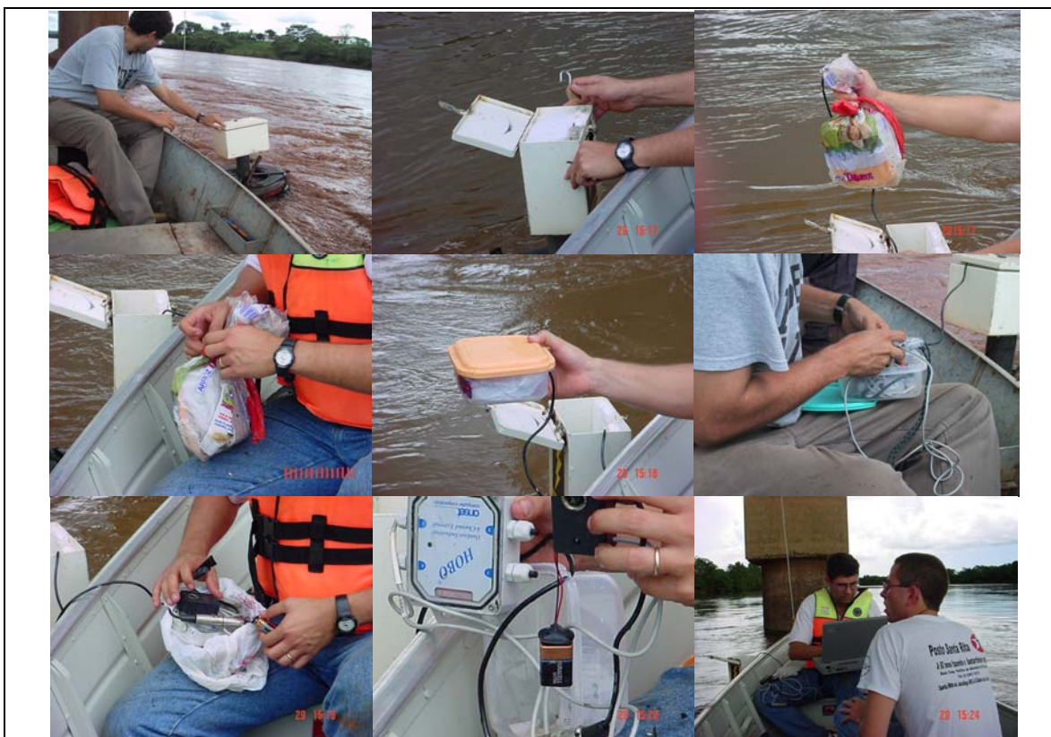
Figura 15. Procedimentos 1 a 4 (manutenção e download de dados das bóias).
