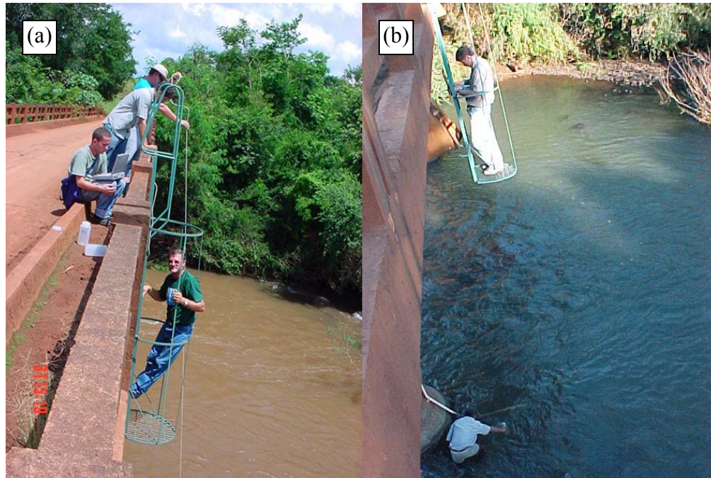
Figura 19. Coleta de amostras (a) por cima (b) por baixo.
