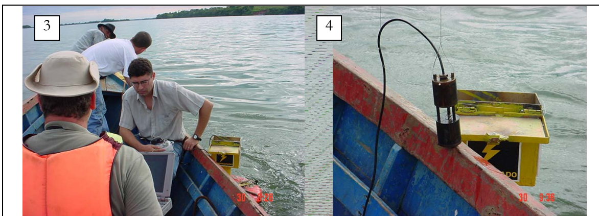
Figura 24. Manutenção da bóia (1) Remover Hobo (2) Verificar funcionamento (3) download via computador ou Shuttle, (3) limpeza de sonda.
