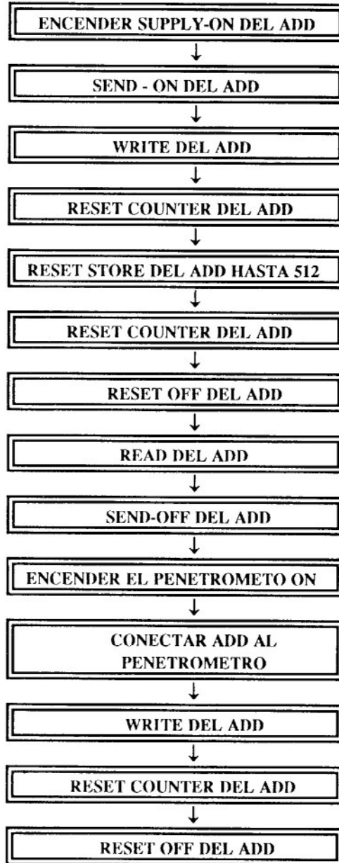
FIGURA No.3: FLUJOGRAMA PARA LA PREPARACION DE ALMACENADOR DE DATOS (ADD) Y SU CONEXION CON EL PENETROMETRO
